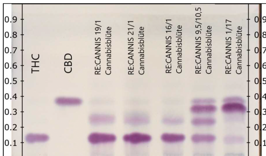
Abbildung 2: Auswertung der Dünnschichtchromatographie der RE:CANNIS Cannabisblüten sowie eines THC-Standards und eines CBD-Standards
