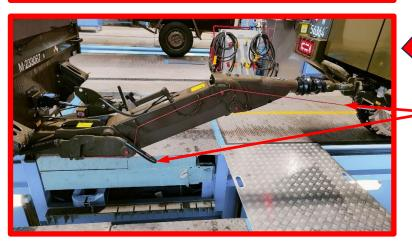
Sobald die Handbremse losgelassen wird, ist das Seil gespannt!
