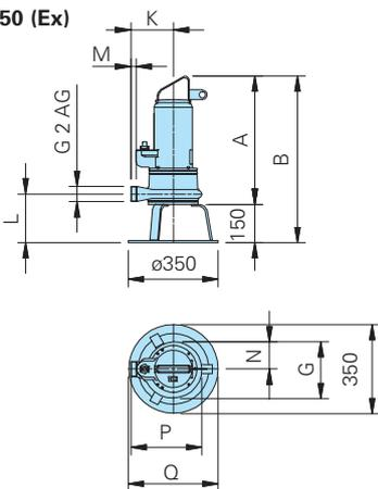
**Schachtinstallation mit automatischem Kupplungssystem**
