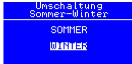
Im Sommerbetrieb erzeugt der Kessel nur Warmwasser.
