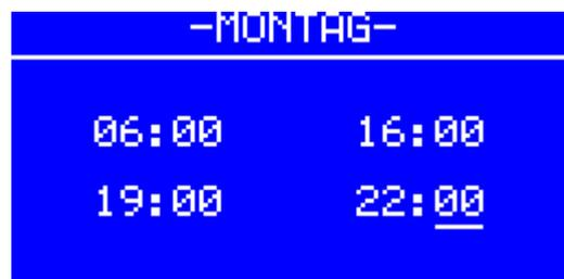
Nachdem alle vier Werte für den Automatikbetrieb eingetragen wurden, erscheint am Display mittig das Wort „Copy“ (Kopieren). Wird dies mit der Eingabetaste bestätigt, werden die Zeiteinstellungen auch auf den nächst folgenden Wochentag übertragen. Durch Drücken der Abbruchtaste gelangt man, ohne die Einstellungen zu kopieren, zur Zeiteinstellung des nächsten Wochentags.
