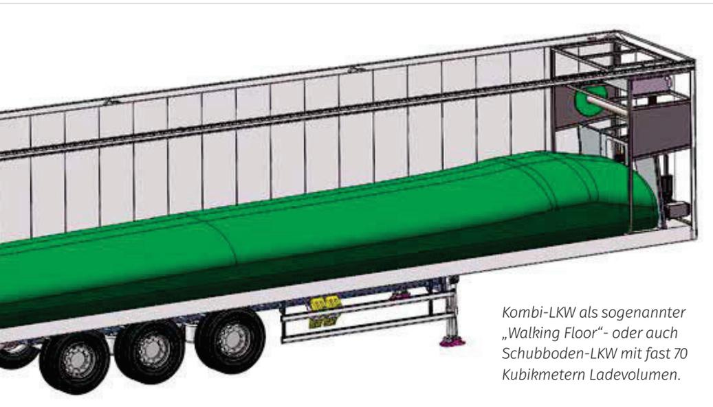
Kombi-LKW als sogenannter „Walking Floor“- oder auch Schubboden-LKW mit fast 70 Kubikmetern Ladevolumen.
