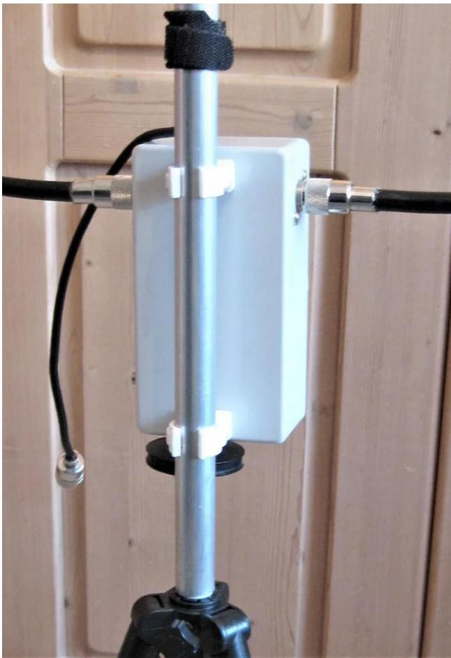
**Gehäuse\*\*** mit Abstimmkondensator, 2 x SO-239 Einbaubuchsen, 2 x Klemmschellen (M 20) für Kabelrohre und Abstimmknopf
