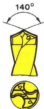
Spitzenanschliff: Kegelmantelanschliff mit Sekundärfreifläche
