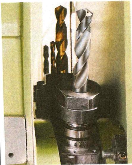
Bild 1.16: Ratioboherer Typ RT 50, mit aufgelötetem Hartmetallkopf, die Spezialisten für die Zerspanung von Guß und Aluminium auf leistungsärmeren Maschinen.
