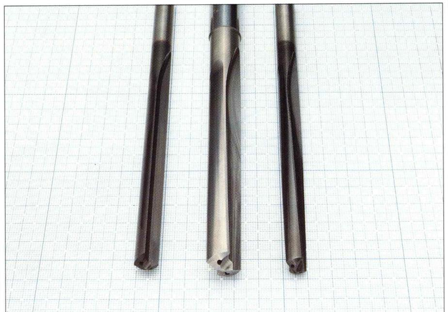
Bild 1.16: VHM-Ratio Bohrer Typ RT 150 GN mit negativer Steigung empfehlen wir speziell für Bohrtiefen über  $10 \times D$ , Typ RT 150 GG mit gerader Nut für Bohrtiefen unter  $10 \times D$ .
