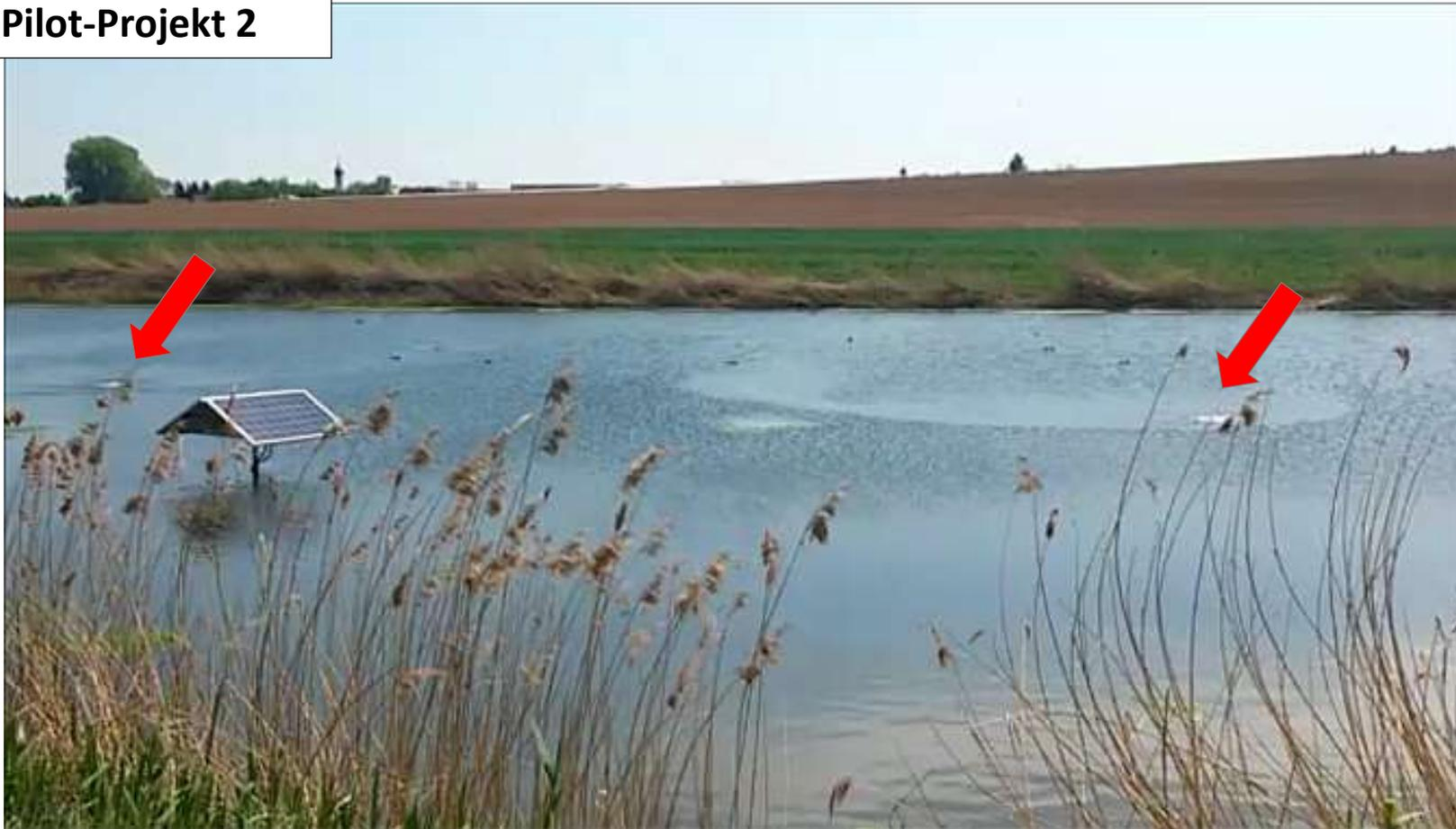
die beiden schräg zur Wasseroberfläche hin fördernden Umwälz-Belüfter mit schrägem Steigrohr (DN250)
