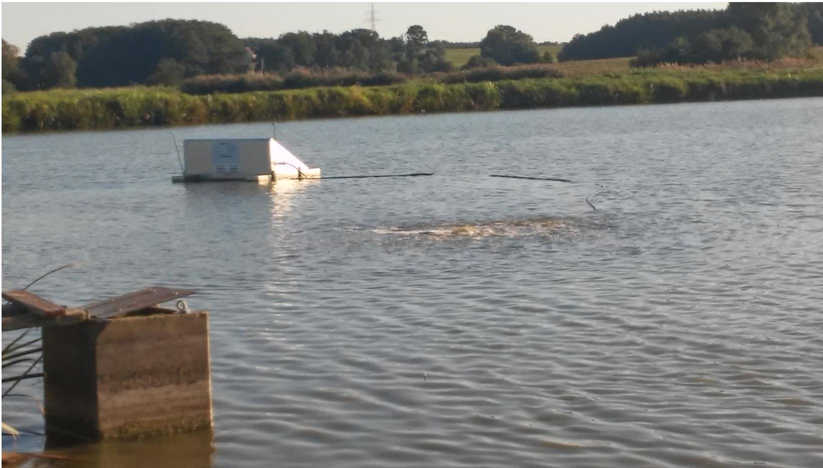
Umwälz-Belüftungs-System mit Solar-Stromversorgung für Fischteiche
