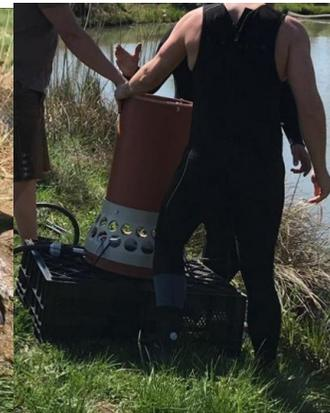
Umwälz-Belüftungs-System mit Solar-Stromversorgung für Fischteiche
