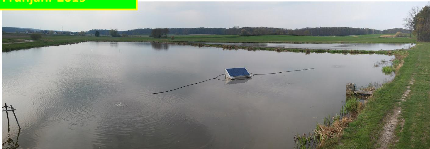
Umwälz-Belüftungs-System mit Solar-Stromversorgung für Fischteiche
