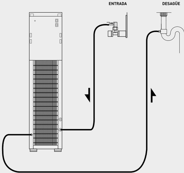
ESQUEMA DE CONEXIONADO HIDRÁULICO MODELOS F Y UF
