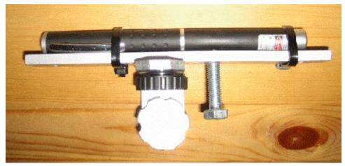
Der Laser muss dann über den Kugelkopf oder das Gelenk einmalig parallel zum Teleskop ausgerichtet werden. Der Laser zeigt durch einen langen Strahl ziemlich genau auf die
