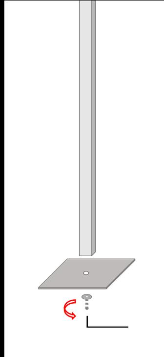
(2) Mit dem Winkelschraubendreher (SW5) wird die Schraube mit U-Scheibe von unten an den Keramikfuß angelegt und in die Stand-Säule eingedreht und angezogen.
