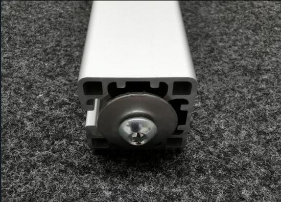
(1) Für die Montage wird zunächst die Schraube (M8x40 mit U-Scheibe) am Fuß der Stange mit Winkelschraubendreher (SW5) gelöst.
