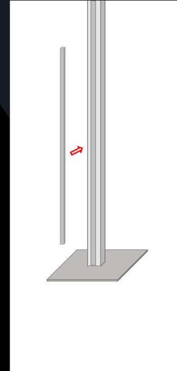
(3) Die Abdeckung kann im Anschluss ganz einfach in die Nut der Stand-Säule eingedrückt werden.
