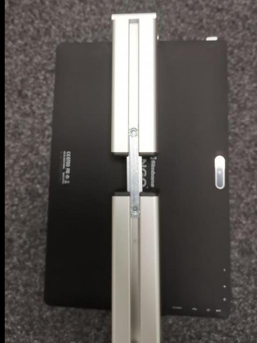
(2) Die obere der beiden Verstellerschrauben mit Winkelschraubendreher (SW4) lösen und die Halterung auf die Größe des Tablets einstellen, Tablet einlegen und die Schraube wieder festziehen.
