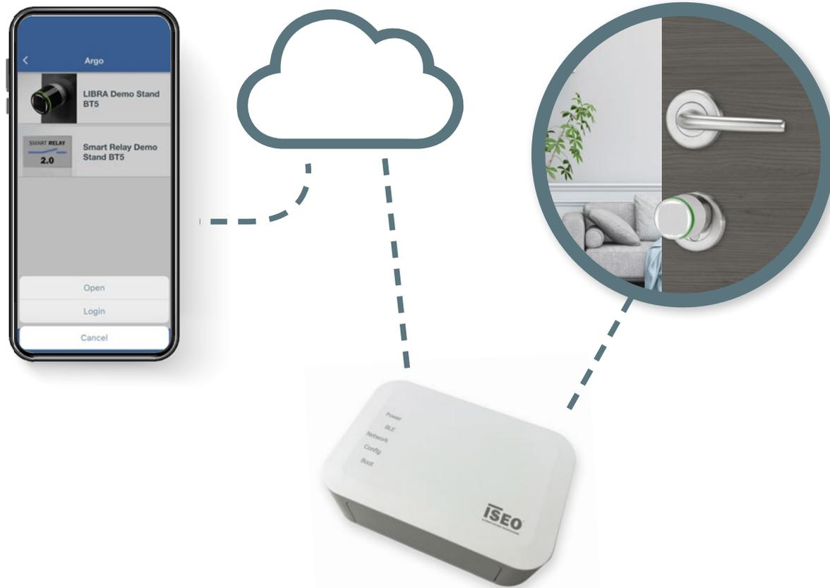
Die Verbindung mit der Cloud von ISEO Argo wird mit TLS 1.3 geschützt.
