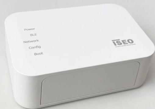
Das Smart Gateway verbindet das Schloss mit der Cloud (ISEO Argo Benutzerkonto). Dabei kommuniziert es mit der Cloud über eine Datenverbindung und mit dem Türschloss über Bluetooth Smart 5.0. Mit dem Smart Gateway können alle Türschlösser innerhalb der Bluetooth-Reichweite (ca. 10 Meter je nach Umgebungsbedingungen) verwaltet werden.
