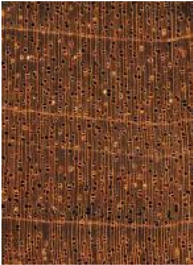
Mahagoni ( Swietenia sp.) – Querschnitt (ca. 12-fach)
