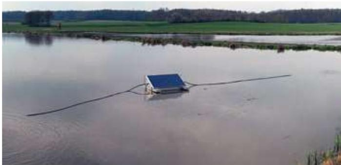
Abb. 4: SolarBelüftungSystem, bestehend aus einer schwimmenden PV-Druckluftversorgung und zwei Flachwasser-Umwälzbelüftern
