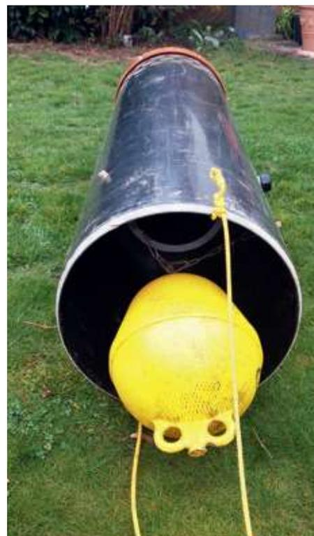
Abb. 7: „schwebender“ DN400-Umwälzbelüfter mit 1,5 m langen Steigrohr
