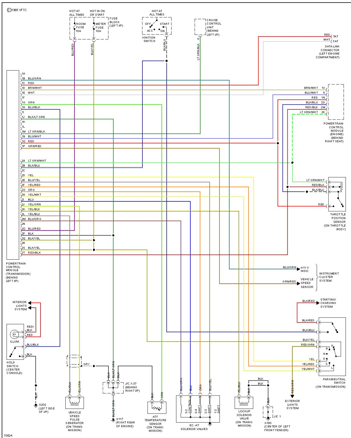
**Fig. 31: Transmission Circuit**
