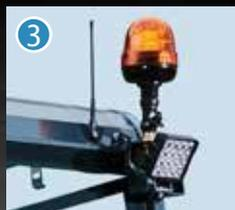
LED-Rücklicht, abnehmbare orangefarbene LED-Rundumleuchte (optional)
