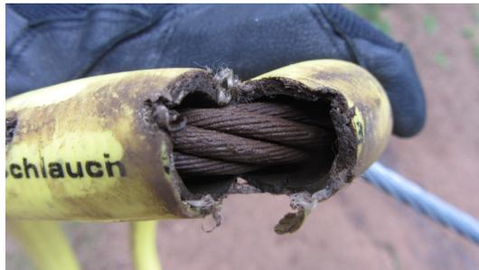
Abspannseile sind manchmal mit Umgebungsmaterial bedeckt, was die Korrosion forciert. Alle Komponenten des Tragwerksystems müssen freigelegt werden, um das Ausmaß der Korrosion feststellen zu können.
