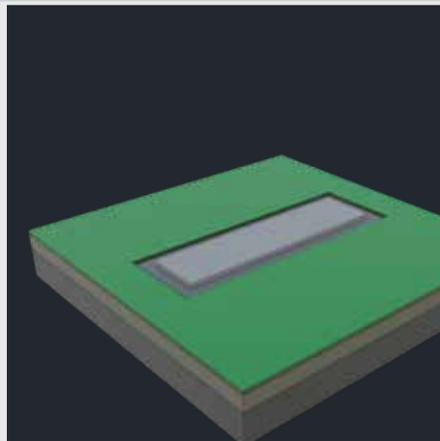
Gießen Sie einen Betonsockel für das Modul. Achten Sie darauf, dass der Betonguss gleichmäßig ist.
