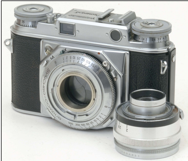
Abb. 6: Voigtlander Prominent. Vorne das Ultron für das Innenbajonett; um den Verschluss herum die vier Führungen für das Außenbajonett.
