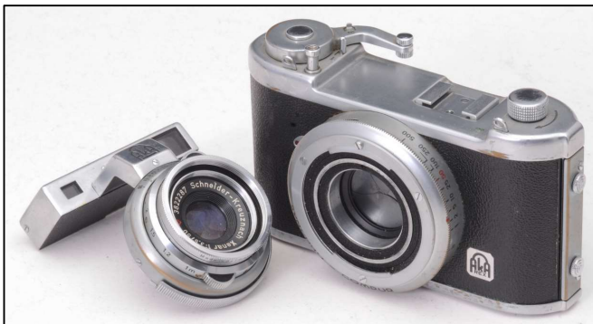
Abb. 3: Akarex mit Zentralverschluss und mit an jedem Objektiv angebauten eigenen Messsucher, 1953
