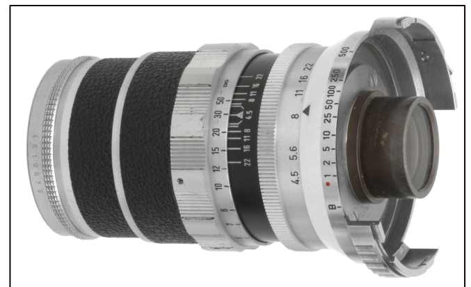
Abb. 13: Beim 100 mm Dynaron ist der Ring um die unbewegliche Hinterlinse federnd gelagert und fest mit dem Frontglied verbunden. Der Rand der Verschlussöffnung liegt an diesem Ring auf und kann dadurch beim Einstellen auf nahe Entfernungen das Frontglied nach vorne schieben.
