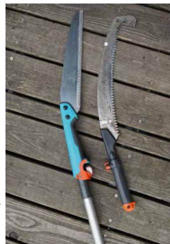
Besonders gebogene Zugsägen mit japanischer Zahnung sind bei etwas stärkeren Ästen bestens geeignet.
