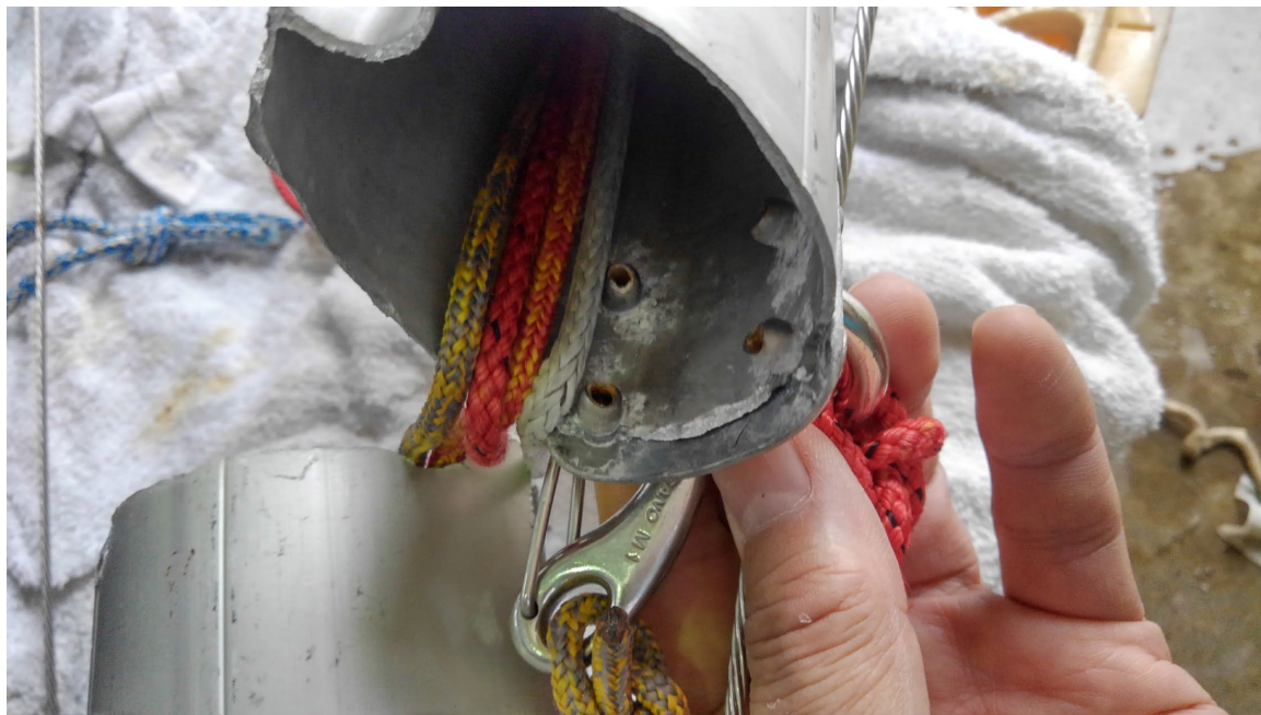
マストアイ取り付けリベットのところで 破損したマスト
