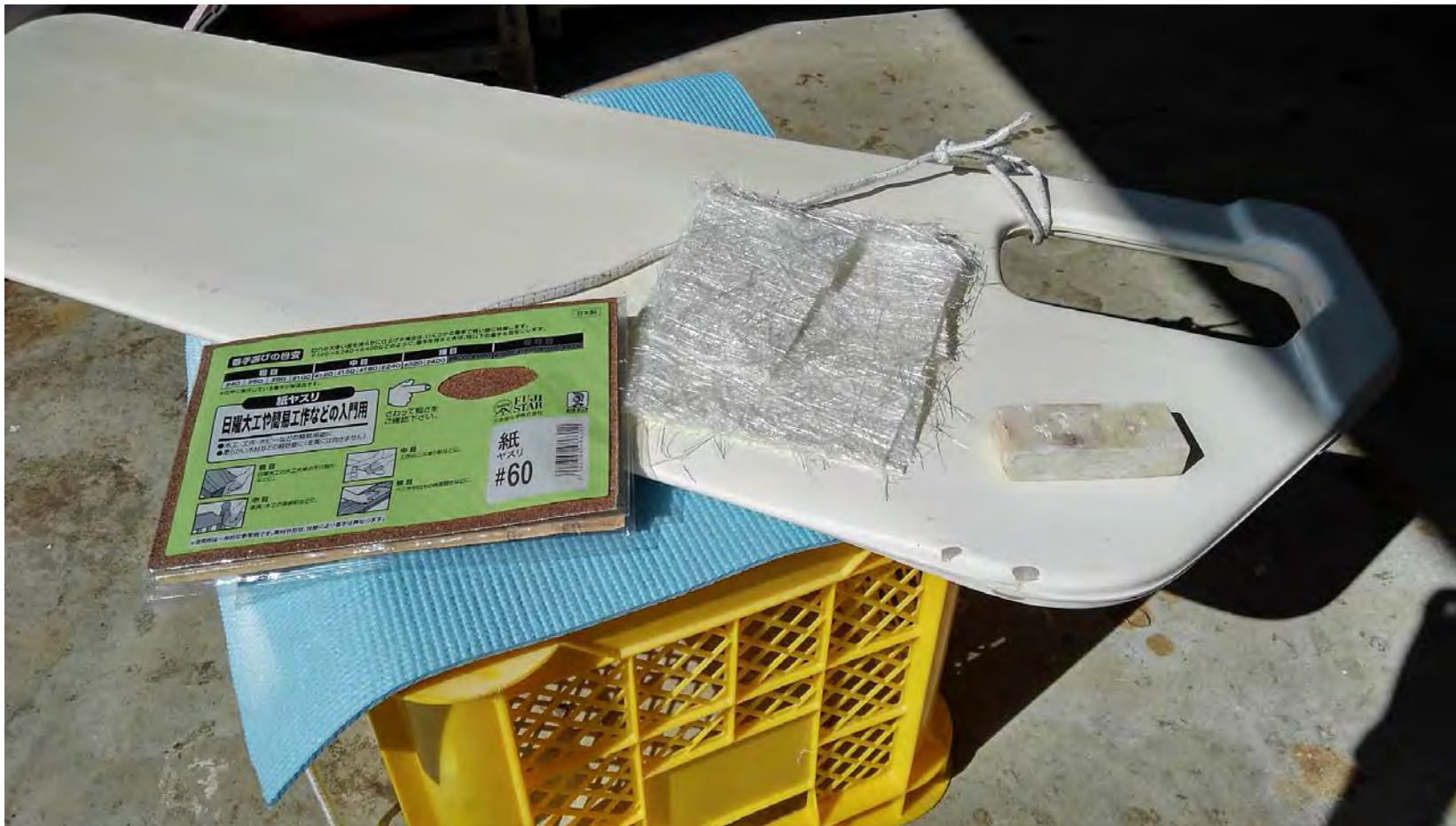
センターボード・ラダーのキズは、サンドペーパーで削りガラスマットを使用
