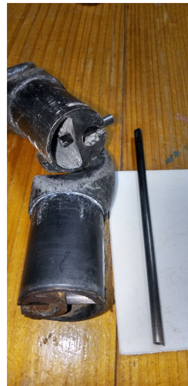
錆ないカーボンロッド でスプリングを止める
