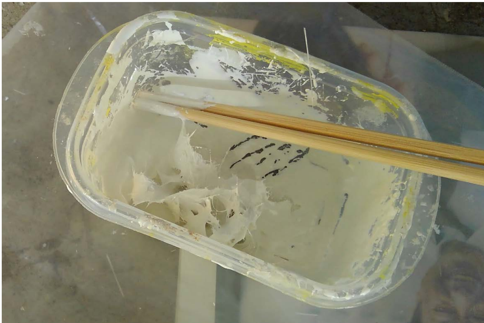
ガラスマットと硬化剤入り樹脂をしっかりと混ぜる
