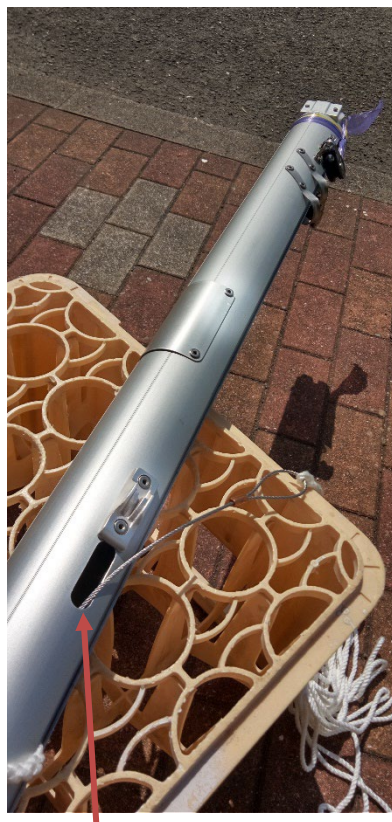
メインハリヤードワイヤー で、マストに切れ目が出る
