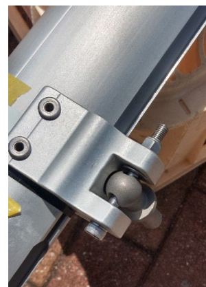
ボルト・ナットが外れなく なるので、 クレストピンに交換
