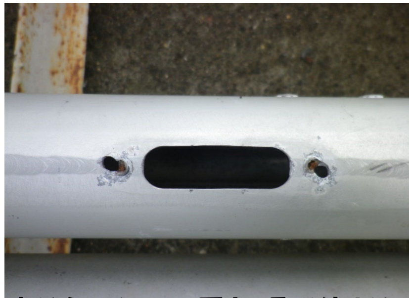
穴が大きくなって再度の取り付けが 不可能になったマスト マストも使用できなくなるッ！
