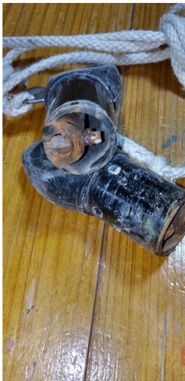
スピンプールエンドスプリング 止めは錆るのでカーボンロッド に交換
