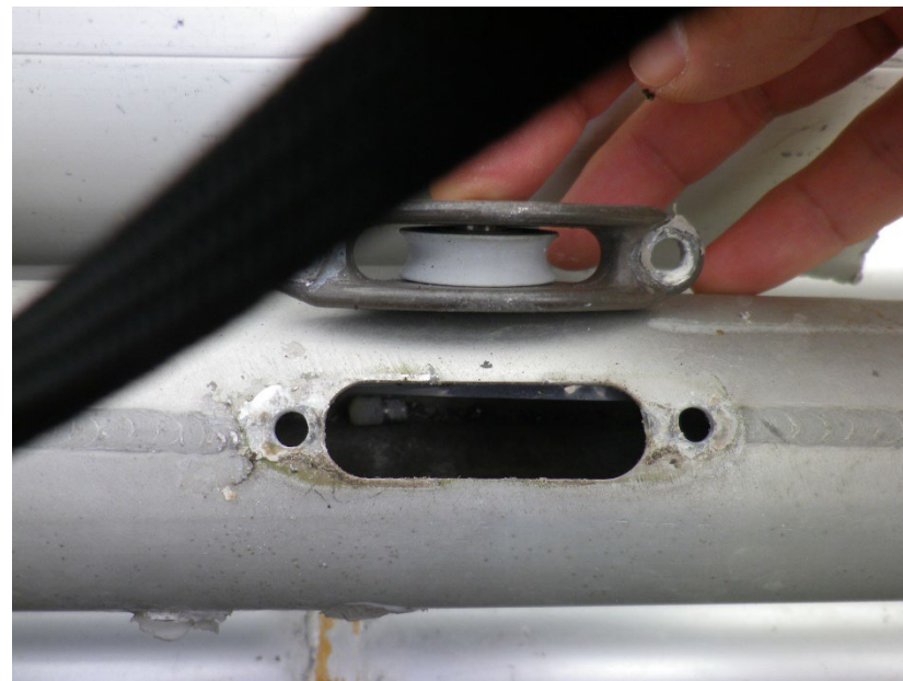
取った部品・マストそれぞれの穴は元のサイズのままで、再度4.8mmのリベットで付け直しができる
