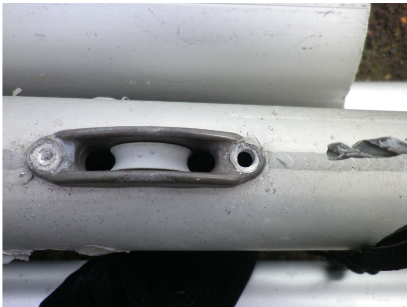
4. 5mmドリルでリベットピンを削り取る
