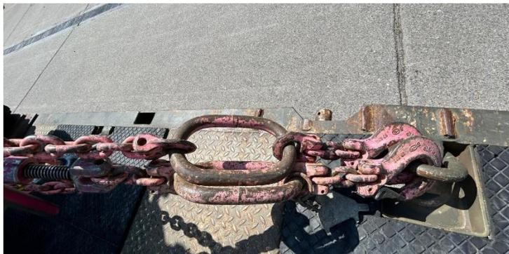
Diese Befestigung eignet sich aufgrund deren Konstruktion NICHT für die diagonale Ladungssicherung.
