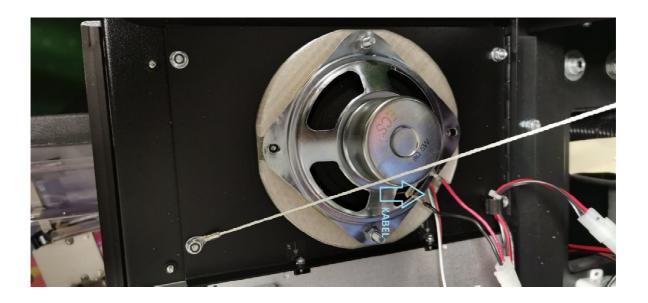
Verbinden sie das Controller-Board mit dem SpeakerLightKit über den 3-poligen Stecker und schließen das System am Flipper an.
