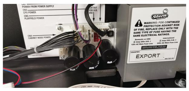
Der Spannungswandler (kleine Schwarze Box) in Backbox platzieren und die Blende wieder schließen.
