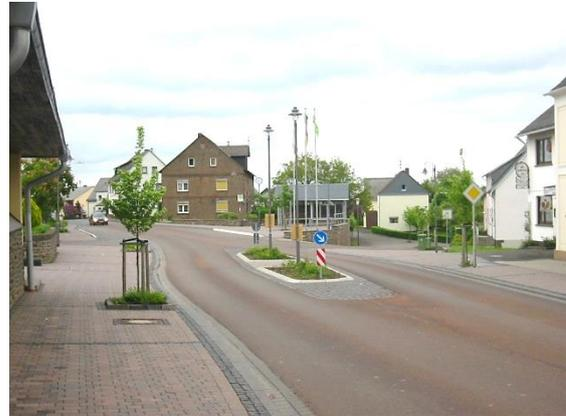
Abb. 48: Fußgängerüberquerung barrierefrei gestaltet in Mastershausen. Fahrbahn und Seitenflächen in braunem Farbton
