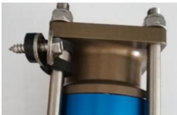
3. Drücken Sie den Kärcher K2-Hochdruckschlauch auf das Ventil, das unten rechts in der Rohrkappe montiert ist. Sichern Sie den Schlauch mit den beiden 2-mm-Stäben gegen Herausrutschen. Wenn Sie verriegelt haben, biegen Sie die Stäbe ein wenig um das Herausrutschen zu vermeiden.
