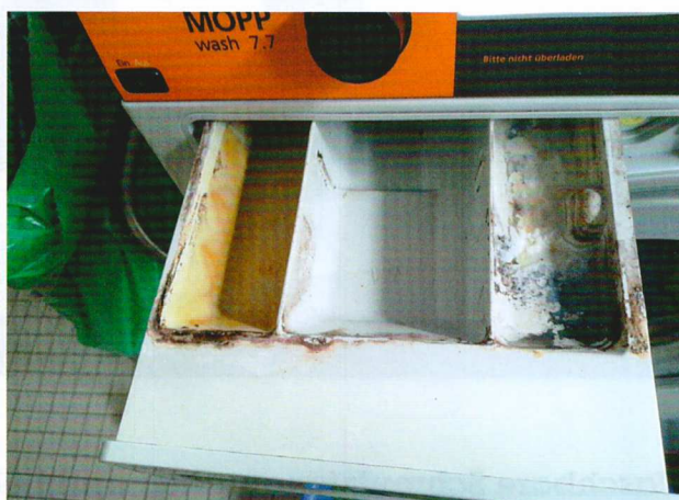
Aufnahmen aus der Praxis von Waschmittelkammern bei automatischer Flüssigdosierung in einem Krankenhaus und Seniorenheim
