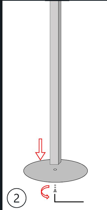
Die Schraube wird von unten (Senkung und Filzpunkte sichtbar) durch den Teller in den senkrechten Pfosten geschraubt und hier mit dem Sechskantschlüssel fest angezogen.
