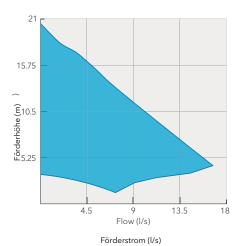
Unser starkes Freistrom-Modell ist robust und äußerst zuverlässig. Es hat ein offenes, zurückgesetztes Laufrad, das Feststoffen und Flüssigkeiten freien Durchgang gewährt. Das Modell kann Schlammkonzentrationen bis 4 % Trockensubstanzgehalt handhaben.
