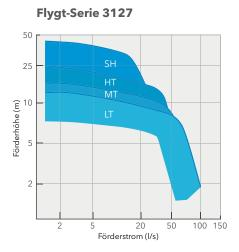
Druckstufen: SH - Superhochdruck, HT - Hoher Druck, MT - Mittelstarker Druck, LT - Niedriger Druck
