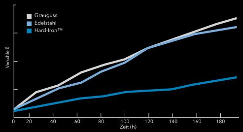
Nach 200 Betriebsstunden wurde deutlich, dass das Hard-Iron-Laufrad fünfmal verschleißfester war als seine Graugussversion. Der Verschleiß des Edelstahllaufrads war vergleichbar mit dem des Graugusses.
