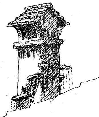
Die Dachtraufe vieler Steindächer springt bloß 20 bis 25 cm vor: Da schien es oft angebracht, über den Eingängen kleine Dächer zu bauen, um das Öffnen der Türen bei Regenwetter etwas angenehmer zu gestalten, versah man das Dach doch nur äußerst selten mit einer Rinne aus einem der Länge nach gespaltenen und gehöhlten Baumstamm.
