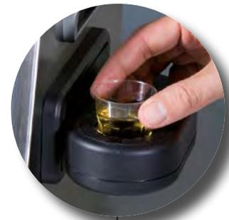
Externer Suchkopf für die Untersuchung von nicht abgefüllten Flüssigkeiten.
