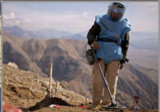
**MIL-D1** ist ein tragbarer und hochempfindlicher Metalldetektor, speziell entwickelt für die Detektion von magnetischen und nicht-magnetischen Metallen in sowohl leitfähigen wie nichtleitfähigen, lateritischen und magnetischen Untergründen.
