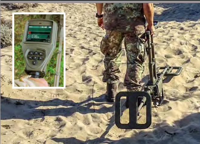
**DSMD:** Digitaler Metalldetektor zur Erfassung von nicht detonierten Kampfmitteln (UXO) und zur Sanierung von Schießanlagen mit integrierten Funktionen der Qualitätskontrolle und unterstützter Bedienung.
