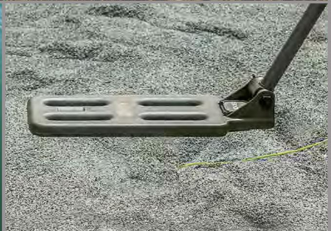
**CWD:** Kompakter Metalldetektor für die Erkennung von Drähten mit beliebigem Durchmesser und einer Mindestlänge von 10 m. Detektionsvermögen unabhängig vom Neigungswinkel des Suchkopfs.
