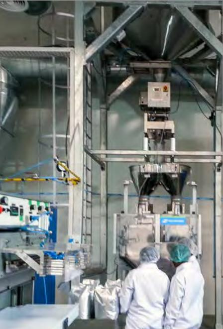
Das integrierte System THS/FFV21 von CEIA ist speziell für die Prüfung von Pulvern und Granulaten und die Eliminierung von magnetischen und nichtmagnetischen Kontaminationen sowie Kontaminationsstoffen aus Edelstahl ausgelegt.
