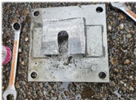
**Beim kaputten Rührwerk 2** war die Führungsstange zur Bodenplatte der Bolzen abgerissen und die Bohrung komplett ausgeschlagen. Die Grundplatte wurde ausgebaut und erneuert. Die Befestigungsmuttern konnten jedoch nicht mehr gelöst werden. Diese wurden abgeschnitten und neue Gewindebolzen eingeklebt. Das noch in Betrieb laufende Rührwerk 1 war auch kurz vor dem Abreißen und wurde repariert. Bei dieser Sanierung wurden auch die gesamte Belüfterteller erneuert.
