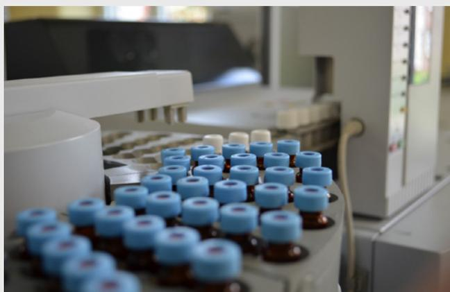
**Bild 1:** Mit Vials bestückter Autosampler eines Gaschromatographen
