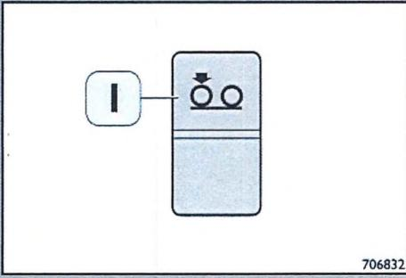
**Schalter Anheben/Absenken Achse (wenn das Fahrzeug mit einer Liftachse ausgestattet ist)**
