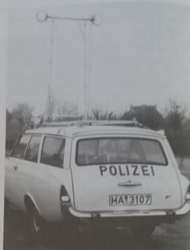
Heckansicht eines weißen Streifenfahrzeuges Ford-Tunier mit hochgestellten Weitwarnleuchten „Super Primär“ auf schwenkbarem Rohrgestell.
