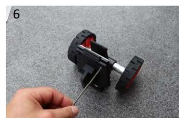
Sobald die Finne demontiert ist, kann der Mover am Board wie folgt angebracht werden:
