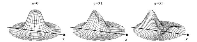
Según podemos ver, cuando aumenta el campo eléctrico la función de onda se va deformando, de modo que el electrón se desplaza en la dirección contraria del campo, lo que produce la aparición del momento dipolar.
