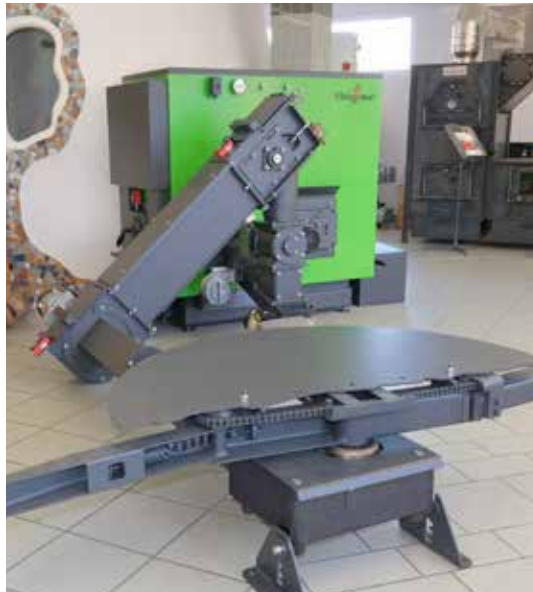
Austragungskanal mit Kettenschrägförderer
