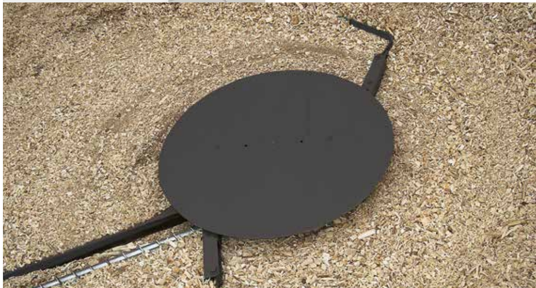
Gelenkarmaustragung mit Schnecke
