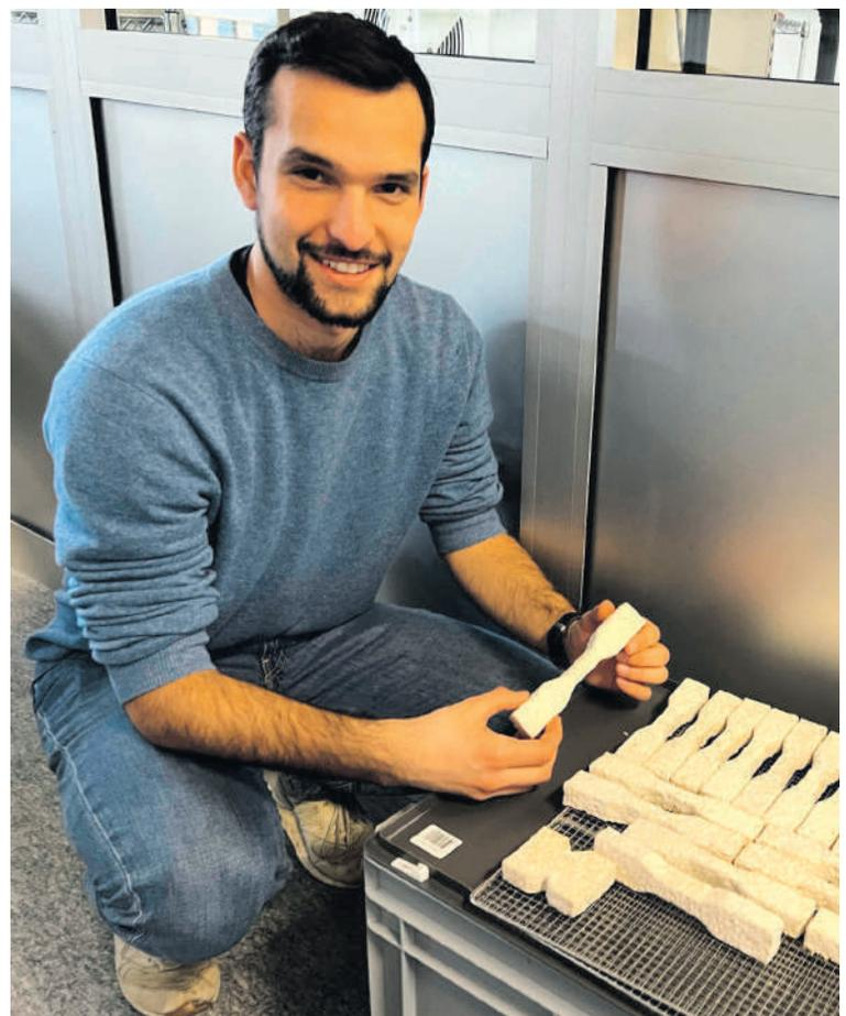
So verlassen die Formen aus Pilzsubstrat den 3D-Printer. Cedric Mennet bereitet sie für den Belastungstest vor. (Bild: Martin Schilling)
