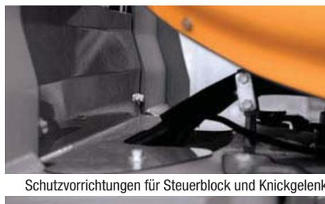
Schutzvorrichtungen für Steuerblock und Knickgelenk
