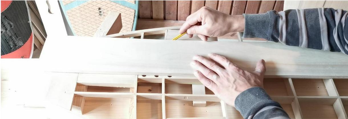
Jetzt auf alle Teile des Gerippes die mit der Beplankung zu verleimen sind, gleichmäßig Leim auftragen. Achte darauf, dass bei allen Outline Teilen genügend Leim aufgetragen ist.
