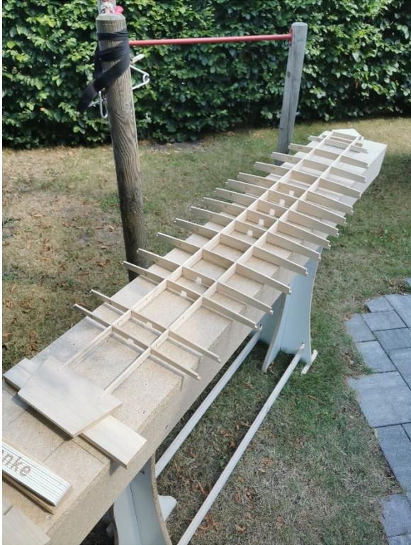
Jetzt die Spannten von 1-15 in die beiden Stringer stecken. Es fängt vom Tail bei 1 an.
