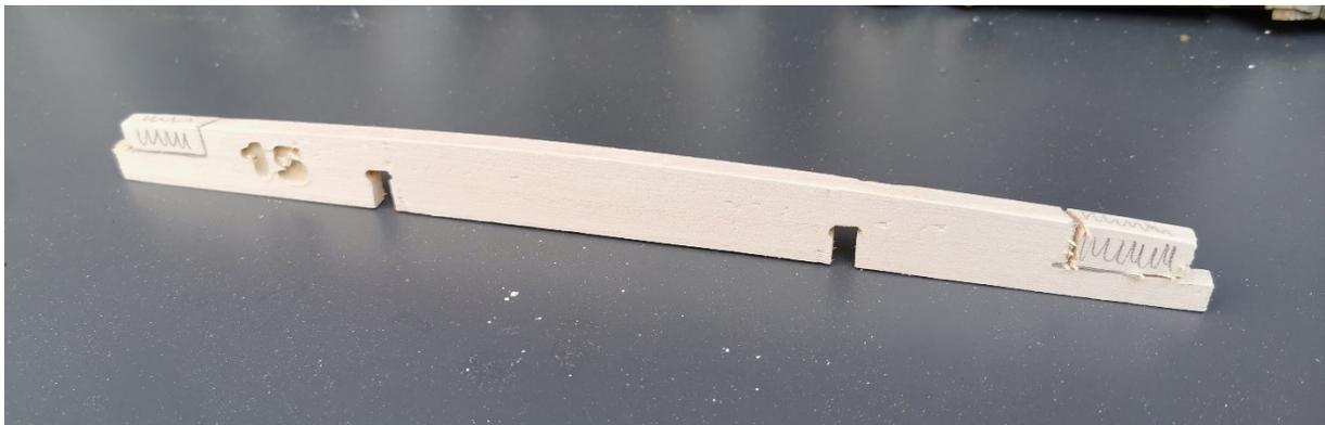
Doch zuerst müssen jetzt die Spannten Nach und nach, aus dem Gerippe herausgenommen, und wie auf dem Bild zu sehen nachgeschnitten werden. Am besten funktioniert das mit Japan,- oder Feinsäge.
