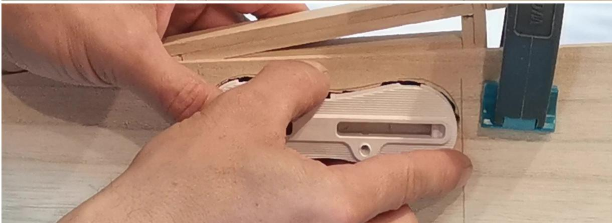
Wenn jetzt alle Beplankungsteile angepasst und vorbereitet sind, kannst Du damit anfangen die Teile aufzuleimen. Ich empfehle die Spannten auf der Beplankung zu markieren, damit man weiß wo die Zwingen ansetzt werden können. Hier kann wer möchte, Ober und Unterseite gleichzeitig verleimt werden.
