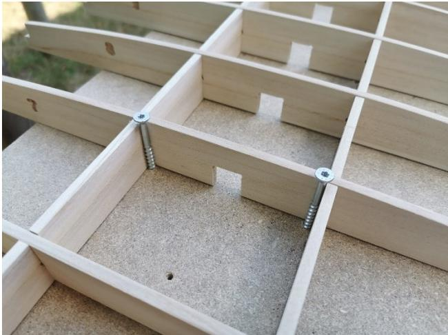
Jetzt muss das Gerippe gegen seitliches verschieben gesichert werden. Dafür werden Schrauben wie auf dem Bild zu sehen an die Ecken in die Grundplatte geschraubt. Das machst du bei jedem 2ten Spannten.
