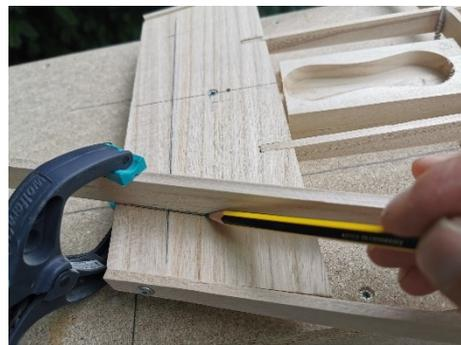
Jetzt ist das Tail festgelegt und du kannst dich der Nase widmen. Im Prinzip funktioniert das wie beim Tail. Dafür musst du als erstes die länge des Boards festlegen. Möchtest du das Board um mehr als 12 cm kürzen, kannst du auch die Spannte 9 entfernen und die Spannten 10 – 15 um je ein Feld nach hinten rücken. Dar der Stringer dann dicker ist als die Spannten empfehle ich, die Spannten immer oben bündig zu positionieren, um in einer Linie zu bleiben und später den Stringer unten anzupassen.
