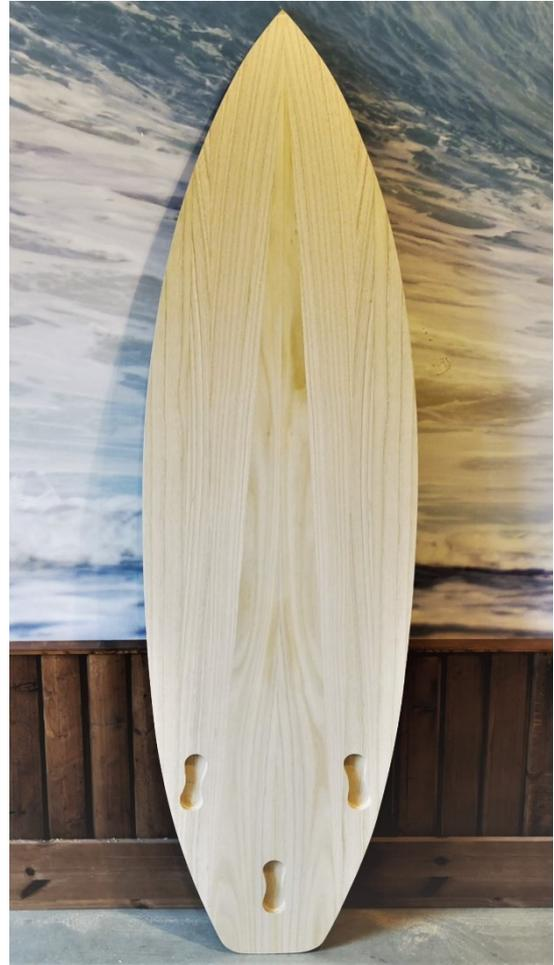
Bevor wir jetzt mit dem Shapen der Rails beginnen können, müssen erst noch die seitlichen überstände verputzt werden. Und anschließend Unebenheiten auf dem Deck und dem Bottom die beim Verleimen entstanden sind zu verschleifen.
