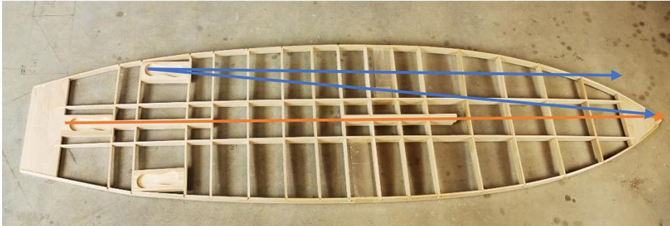
Der Winkel sollte wie auf dem Bild zu sehen innerhalb der beiden Blauen Linien liegen. Dieser Winkel beeinflusst die Drehfreude und die Geschwindigkeit.
