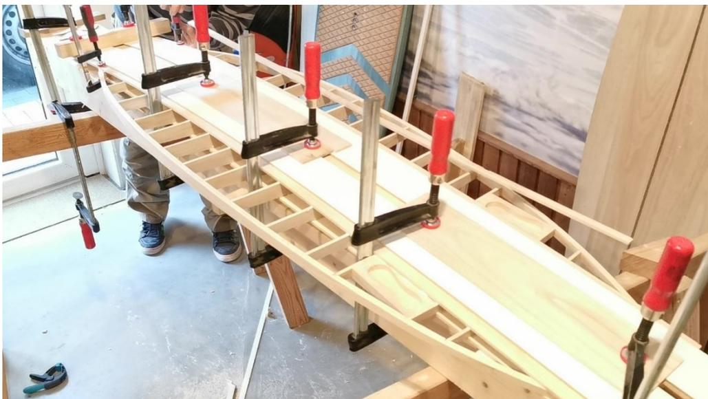
Sobald dieses Teil getrocknet ist, kannst Du den anderen Mittelteil beplanken. Falls Du zwischen den beiden Beplankungsteilen einen Spalt hast, kannst Du das entweder mit einer Zwinne zusammenziehen oder das Beplankungsteil nacharbeiten.
