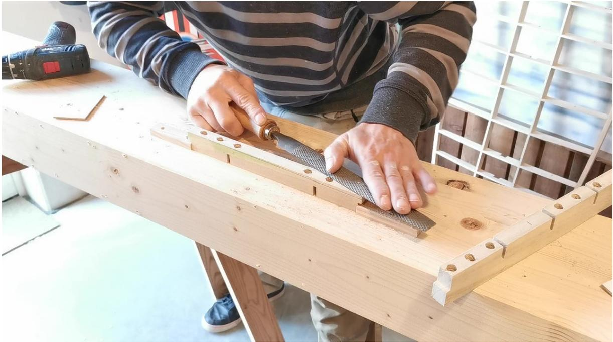
Im Anschluss die die Überstände zum restlichen Gerippe anarbeiten und anpassen. Am besten ganz am Schluss noch einmal mit dem Schleifbrett alles komplett überschleifen.
