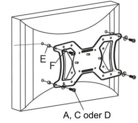
Wenn die Lochabstände Ihres TV-Gerätes einen VESA Standard größer 400 x 200 haben, so montieren Sie wie hier abgebildet die Adapterplatten, um einen maximalen VESA Standard von bis zu 600 x 400 zu erreichen.
