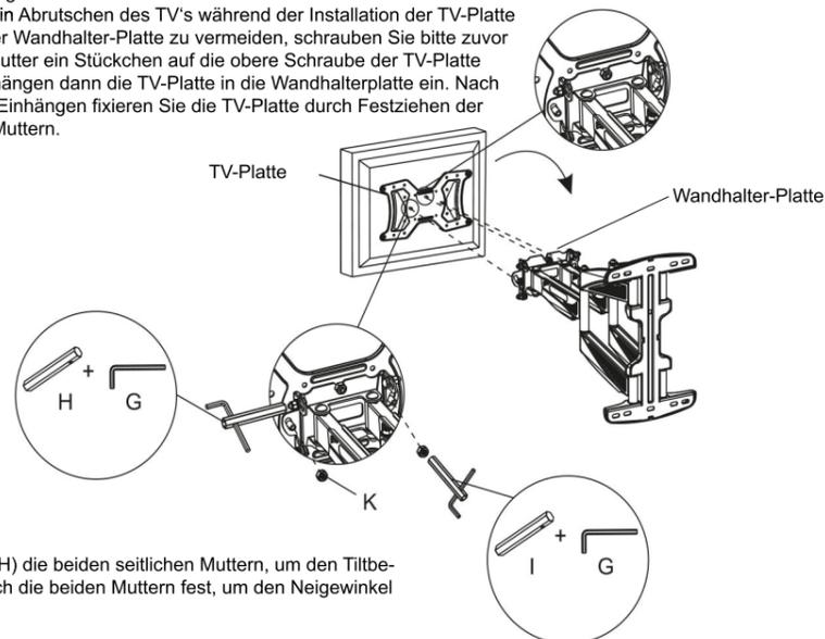
Lösen Sie mit dem Steckschlüssel (H) die beiden seitlichen Muttern, um den Tiltbereich einzustellen. Ziehen Sie danach die beiden Muttern fest, um den Neigungswinkel dauerhaft zu fixieren.
