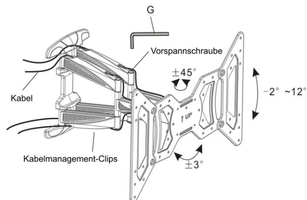
Verlegen Sie die Kabel wie auf der Grafik ersichtlich zu Ihrem TV-Gerät und fixieren Sie diese mit den beiliegenden Kabelmanagement-Clips in Position. Achten Sie darauf, keine Kabel zu quetschen oder zu überspannen.
