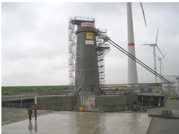
Testfundament mit Turmschaft und Zugeinrichtung für Testversuche
