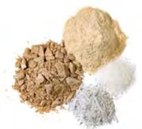
Der Unterschied zu GCC HOLZart liegt bei GCC HARZart darin, dass ein Teil der Inhaltsstoffe durch recyceltes Kunstharz ersetzt wird. So ergibt sich ein Holzanteil von mind. 50%. Die restlichen 50% ergeben sich aus dem Kunstharz, den Polymeren und den Additiven. Der Kunstharzanteil verleiht dem Werkstoff seinen Namen.
