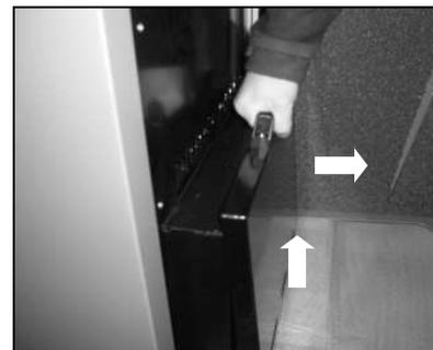
Bild 2: Aschebehälter entnehmen
