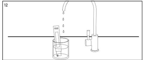
**! ATENCIÓN:** *en caso de detectar que el agua dispensada no cumpliera con la legislación nacional vigente vuelva a realizar la medición. Si la desviación persiste cierre la llave de entrada del equipo, vacíelo a través del grifo, desconéctelo eléctricamente y póngase en contacto con su servicio técnico.*
