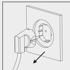
Lea el apartado **INTERFACE** de la *Ficha Técnica*. En caso de anomalía póngase en contacto con el SAT y proceda según se indica: Cierre la llave de entrada. Abra el grifo para despresurizar el sistema y desconecte el enchufe.
