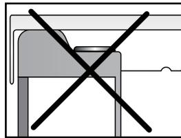
in.k500 muss außerhalb des Whirlpools installiert werden, damit sich kein Schimmel an der Abdeckung bildet.
