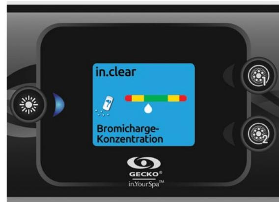
Wenn Bromicharge zugeführt wird, bewegt sich die Anzeige langsam nach rechts. Wenn Sie Wasser hinzufügen, bewegt sich die Anzeige langsam nach links. Um den richtigen Level an Bromicharge zu bekommen, starten Sie die Pumpen und fügen Sie die angegebene Menge an Bromicharge zu. \*\* Warten Sie 5 Minuten, bis sich die Anzeige eingestellt hat, bevor Sie weiteres Bromicharge hinzugeben.
