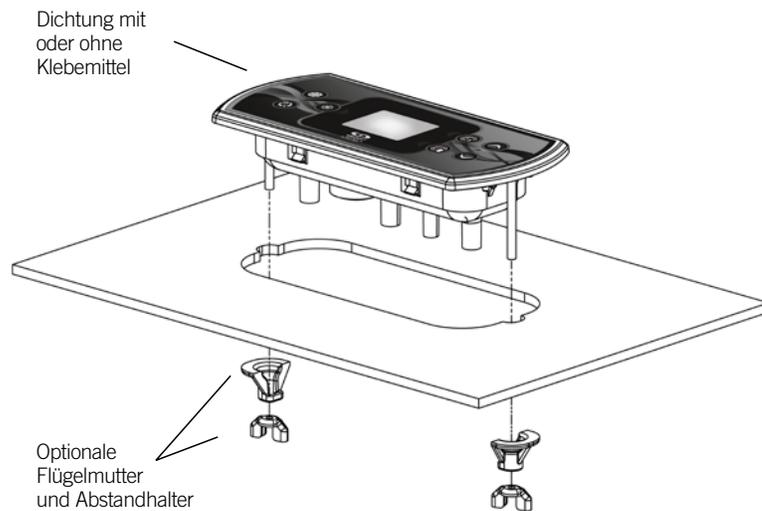
Für die Installation von in.k500 benutzen Sie bitte die beigegefügte Bohrschablone.
