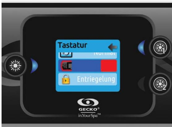
in.k500 mit einer wählbaren Umrandungsbeleuchtung: Ist die Option „Hintergrundbeleuchtung“ in der Spa-Konfiguration aktiviert, erscheint eine Option, mit der die gewünschte Farbe für die Tastatur ausgewählt werden kann.
