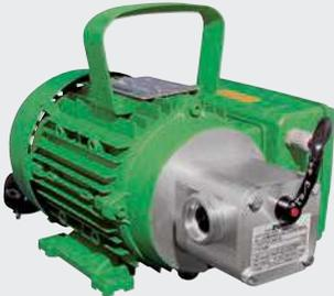
Die Impellerpumpen können zusätzlich mit einem Trockenlaufschutz ausgestattet werden. Zum Schutz des Impellers unterbricht ein Sensor die Stromversorgung bei Überhitzung. Einfache Nachrüstung auch bei vorhandenen Pumpen möglich.
