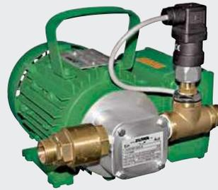
Der Druckschalter schaltet die Pumpe bei Erreichen eines voreingestellten Druckes ab. Sobald der Druck um 30% abfällt, schaltet sich die Pumpe automatisch wieder ein. (Nur für 400 V Pumpen)
