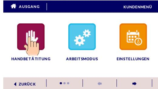
Nun können alle angesteuerten Bauteile separat aktiviert und getestet werden.
