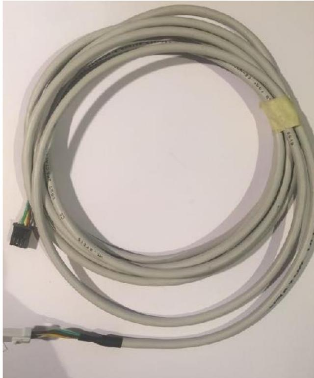
Das DMX-Kabel dient der zweiseitigen Kommunikation von der Treiberplatine zur Soundplatine. Die Soundkarte, die später besprochen wird, ist die mit der die ZA-Elektronik verbunden ist. Diese Verbindung erfolgt über ein 6-poliges<-> Soundboard-Kabel. Falls der IP68-Anschluss von der Switthpod-Relaisplatine verwendet wird, kann die Soundplatine an eine ZA-Relaisplatine angeschlossen werden.
