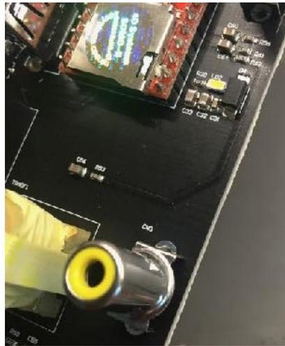
Auf der Soundplatte befindet sich außerdem ein Relais, das die Steuerung eines externen Verstärkers ermöglicht (12V werden geschaltet). Der RCA-Hauptausgang wiedergegebene Sound kann somit(zusammen NUR MIT Entkopplungsfilter) über eine Endstufe verstärkt werden. Dieses Relais dient der „Durchschaltung“ Ihres Remote Signals des Verstärkers. Es kann 5 Ampere bei 12 Volt liefern. Der Kontakt ist nicht geschützt und in der gemeinsamen Leitung muss eine 5-Ampere-Schutzsicherung eingebaut werden.
