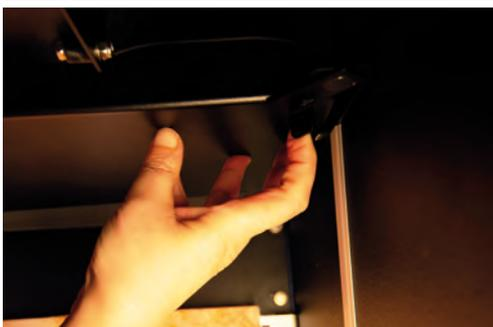
Öffnen Sie die beiden Riegel der schwarzen Abdeckung oben.
